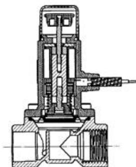
Клапан предназначен для использования в качестве запорного устройства трубопроводных магистралей и газогорелочных устройств с рабочей средой в виде природного газа по ГОСТ 5542-2014, паровой фазой сжиженного углеводородного газа по ГОСТ Р 34858-2022 или воздуха с давлением до 0,01 МПа.
