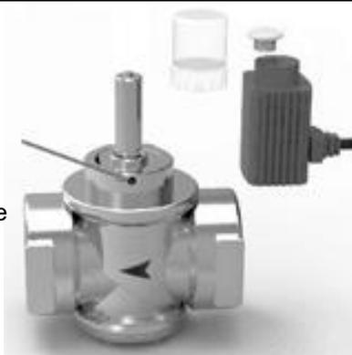
Для открытия клапана в ручном режиме необходимо снять защитный прозрачный колпачок и потянуть красный диск вверх до упора. После этого не забудьте установить защитный колпачок на место.
