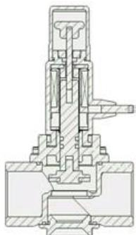
Клапан предназначен для использования в качестве запорного устройства трубопроводных магистралей и газогорелочных устройств с рабочей средой в виде природного газа по ГОСТ 5542-2014, паровой фазой сжиженного углеводородного газа по ГОСТ Р 34858-2022 или воздуха с давлением до 0,1 МПа.
