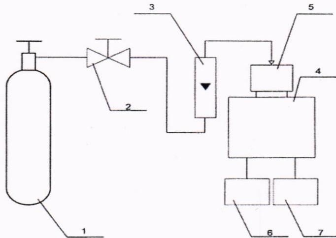
1 – баллон с ПГС; 2 – вентиль точной регулировки (или редуктор баллонный); 3 – индикатор расхода (ротаметр); 4 – сигнализатор (показан условно); 5 – насадка адаптер для подачи ПГС; 6 – клапан управления (при наличии); 7 – подключение к сети переменного тока.
